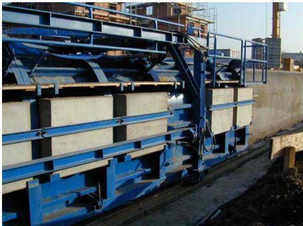
Abb. 14: Schalungsmaschine (Schalungsdummy)
